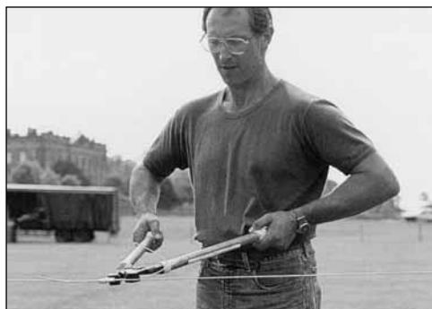
Opstramning med Gripple værktøj (16611).
