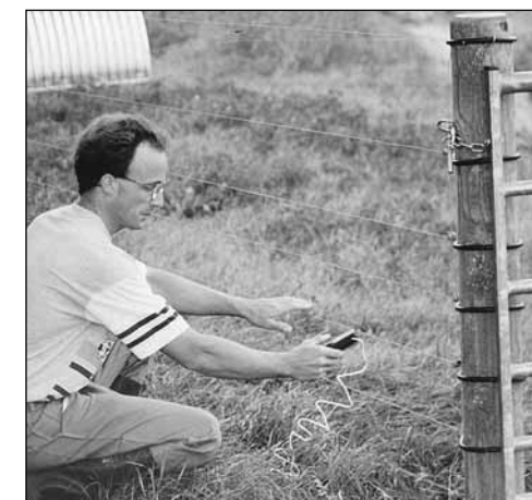
Med SmartPower Fjernbetjening (19413) kan du tænde og slukke for hegnet, uanset hvor du befinder dig på ejendommen.
