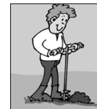
1. Hjørnepælene af trykimpregneret norsk fyr bores eller nedrammes minimum 120 cm i jorden.
