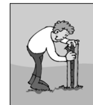
2. Hjørnerør (varenr. 14669) monteres på hjørnepælene. For at være sikker på den rigtige trådafstand, kan du bruge et bat som "målepind".
