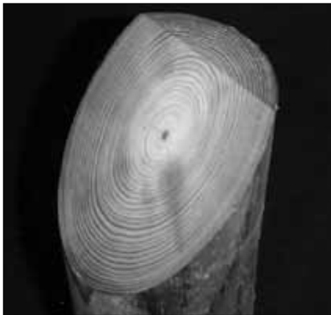
Tværsnit af norsk trykimprægneret fyr. Bemærk de tætte årringe.
